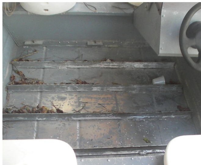
Imagem 35 e 36 (substituição do piso da embarcação, por chapa de alumínio 3 mm)
