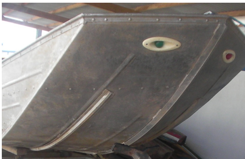
Imagem 38 (Reforço estrutural no casco da embarcação)
