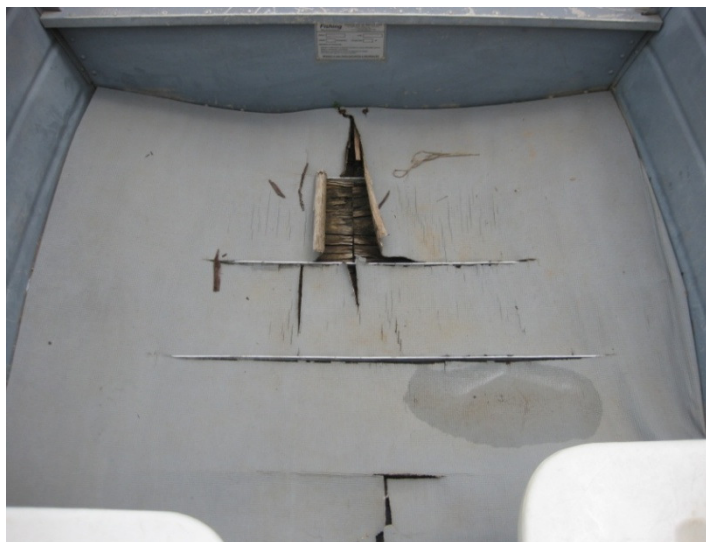
Imagem 35 e 36 (substituição do piso da embarcação, por chapa de alumínio 3 mm)
