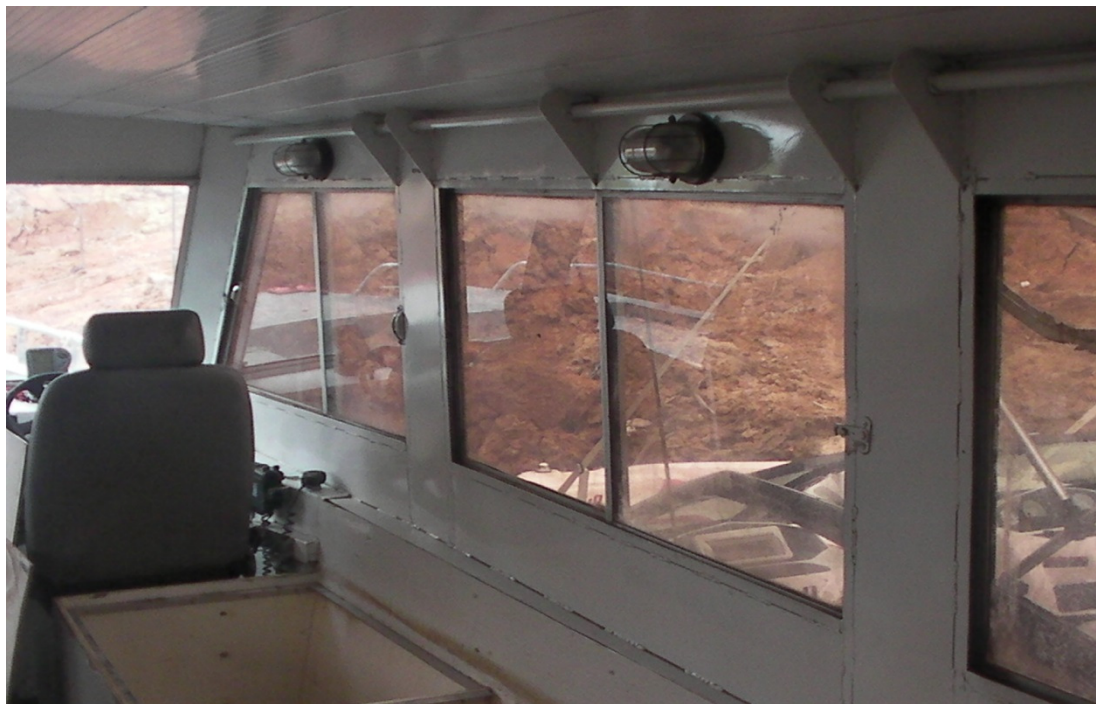
Imagem 21 (pintura completa da parte interna da embarcação)
